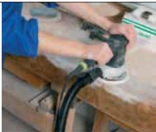
Unsere Sicherheitssauger sind entsprechend der Normen für ATEX Zone 22 oder Zone 2 geprüft. Nach dem Gesetz darf nur das als "verwechslungssicher" zugelassene Spezial-Zubehör TYPE 22 eingesetzt werden.
