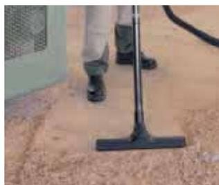
Alle Geräte der M-Klasse werden mit einem antistatischen Schlauch ausgeliefert, um Stromschläge zu vermeiden. So werden auch elektrostatische Anziehungskräfte ausgeschaltet, welche die Verschmutzung des Saugschlauches verstärken.
