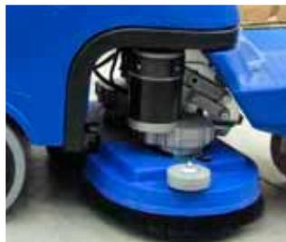
Das neuartige, federnd aufgehängte Bürstendeck ist mit dem Lenkrad gekoppelt. Fährt die Maschine eine Kurve, schwenkt das Bürstendeck in die entsprechende Richtung. Somit wird die Fahrspur der Maschine immer perfekt abgedeckt und die Saugleiste folgt optimal der Wasserspur. Seitliche Saugleisten sind damit überflüssig geworden. Damit erzielen Sie bestmögliche Reinigungsleistung bei höchstem Komfort und geringstem Aufwand.
