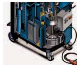
Der Seitenkanalverdichter ist aus Aluminiumdruckguss hergestellt und auf der Grundplatte des Gehäuses befestigt. Somit gibt er der Maschine mehr Stabilität. Das Lüftungsrad wird direkt angetrieben und verringert somit die Wartungskosten.
