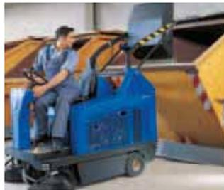
Zur einfachen Entleerung des 130 Liter Kehrgutbehälters ist die Maschine mit einer hydraulischen Hochentleerung ausgestattet. Damit lässt sich der Behälter in Containern mit unterschiedlichen Höhen entleeren. Die maximale Entleerhöhe liegt bei 1,5 Metern.
