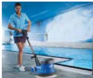
Die SPINTEC 343 Einscheibenmaschinen sind in zwei verschiedenen Ausführungen verfügbar. Sie sind für Standard-Anwendungen wie Schrubben oder Shamponieren ausgelegt.
