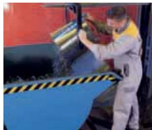
Der große Edelstahlbehälter ist herausnehmbar und verfügt über eigene Lenkrollen. Dies vereinfacht das Entleeren.
