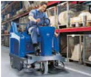
Die robuste FLOORTEC R 680 ist für den langen und harten Einsatz konzipiert. Mit einer Flächenleistung von bis zu 4.780 Quadratmetern pro Stunde, einer Steigfähigkeit bis zu 20 Prozent und hydraulischer Hochentleerung kann sie sowohl im Innenbereich (batteriebetrieben) als auch im Außenbereich (benzinbetrieben) eingesetzt werden.
