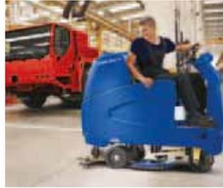
Das BOOST™ Schrubbdeck verwendet eine einzigartige, orbitale Schwingbewegungen mit einer Drehzahl von 2250 U/min. Die Reinigungsmittellösung wird über ein Pulsdosiersystem zugeführt.
