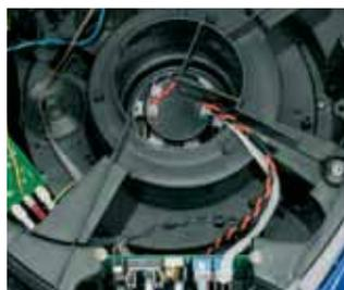
Der EC-Motor ist ein bürstenloser, langlebiger Motor. Ein verschleißarmer Betrieb und die zündquellenfreie Bauweise sind nur zwei von vielen Vorteilen.
